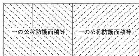
第24-9図 防護対象物が大きく一の装置で警戒できない場合
